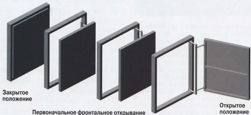
Рис. 1. Схема открывания дверцы ревизионного ЛЮКА-НЕВИДИМКИ®.
