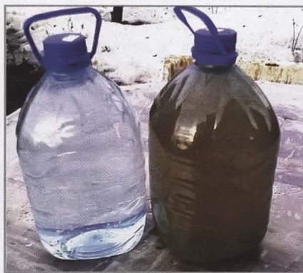
Вода после септика должна быть грязно-бурого цвета, прозрачной и не пахнуть (для сравнения рядом показана канистра с водой из скважины).
