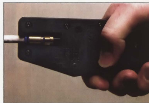
Коаксиальный кабель подключают с помощью F-разъёма, который крепят специальным инструментом.
