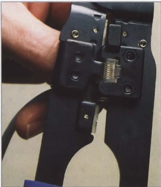
Разложив провода в разъёме, контакты последнего прижимают к проводам обжимным инструментом (тримпером).
