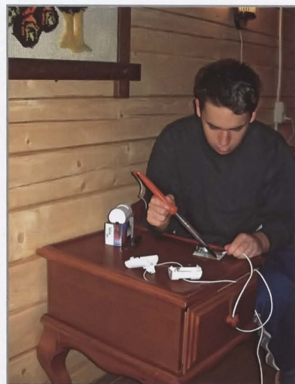
Для обеспечения надёжных контактов концы проводов перед закреплением в клеммах тщательно облудили.
